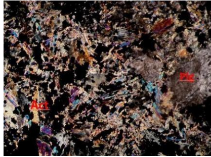
Sector microdiorítico, constituido por plagioclasas (Plg), actinolita (Act) y minerales opacos. (Aumento 100x, Luz Ref., Nícoles cruzados).
