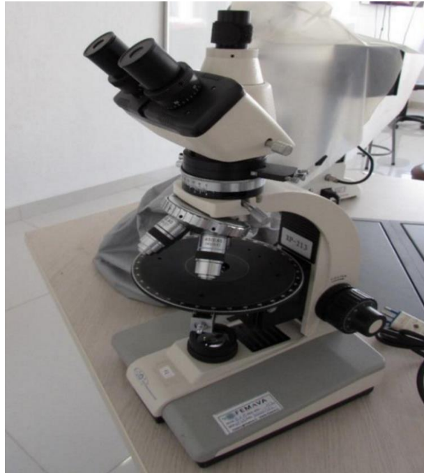
Figura 4.2: Microscopio Leitz LABORLUX S utilizado para la descripción microscópica de la roca.
