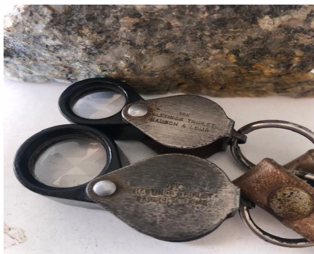
Figura 4.1: Lupas 10x y 14x utilizadas para la descripción macroscópica de las rocas.
