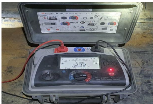
Figura N°3.13: Equipo "medidor de aislación entre bobinas" realizando pruebas de comisionamiento a transformador.
