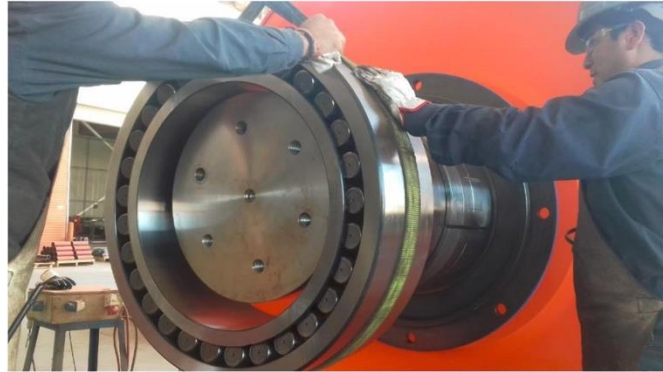
Imagen 10 Posicionamiento del rodamiento de la zona fija
