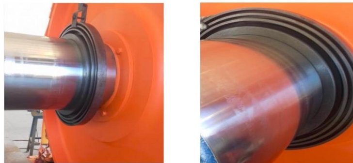
Imagen 5 Posicionamiento y montaje del laberinto.
