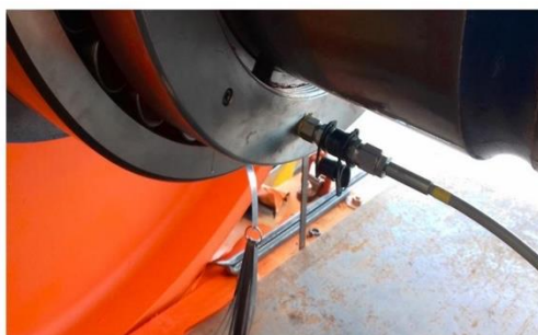
Imagen 16 Determinación de juego radial interno final para rodamiento fijo.
