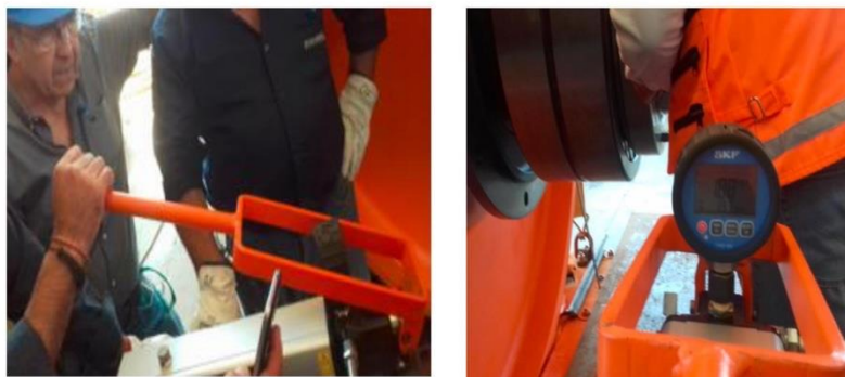
Imagen 15 Izq. Bombeo de bomba hidráulica accionada manualmente, Der. Manómetro marcando la presión de referencia 1.89 MPa.
