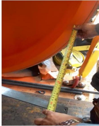
Imagen 13 Medición desde el manto hasta el final de la polea en la zona fija.
