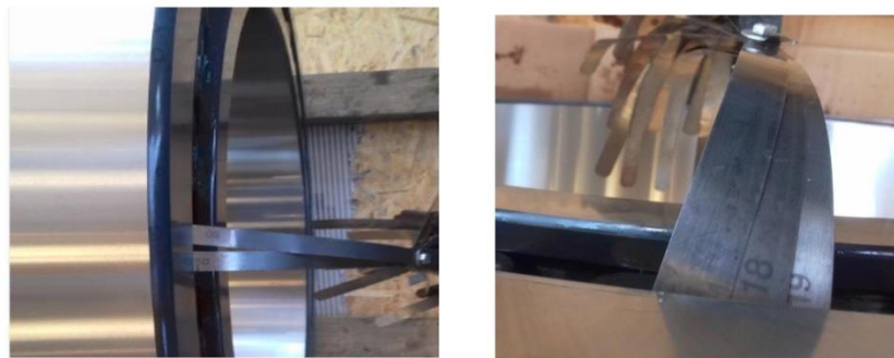
Imagen 2 Juego radial interno previo al montaje, a la izquierda corresponde a la zona fija y a la derecha zona móvil.
