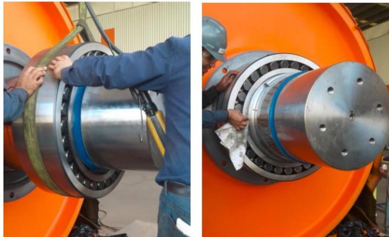
Imagen 11 Posicionamiento del rodamiento de la zona móvil.
