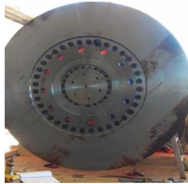
Imagen 23 Montaje de disco de freno.
