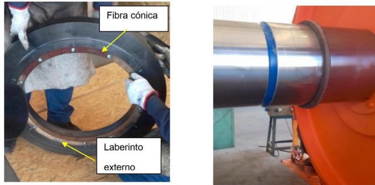
Imagen 4 Presentación de Fibra cónica y laberinto, posicionamiento fibra cónica
