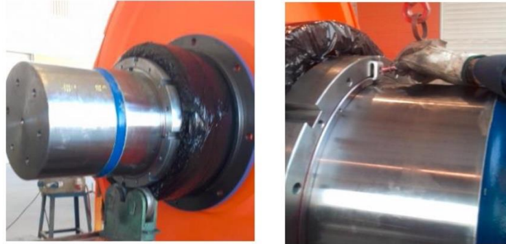
Imagen 17 Tuerca mecánica montada el manguito para apretar al rodamiento y sujeción de traba.
