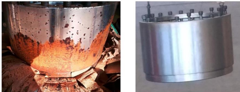
Imagen 20 manguito oxidado y manguito nuevo.
