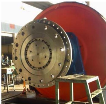
Imagen 22 Montaje del manguito Bikon Hydro-press con el machón Bikon.
