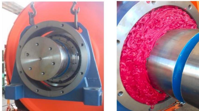
Imagen 18 Posicionamiento de los soportes y engrasado final.
