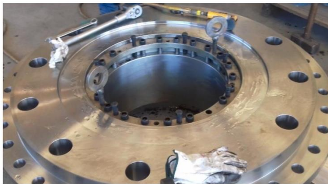
Imagen 21 Montaje entre manguito y machón.
