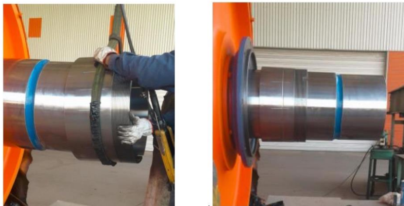
Imagen 9 Posicionamiento de manguito cónico en eje en la zona móvil de la polea.
