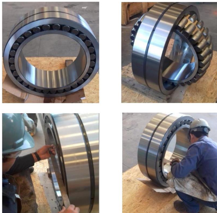
Imagen 1 Inspección de rodamiento SKF, mediciones, acciones de lubricación y limpieza.
