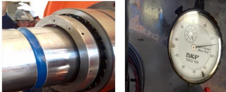
Imagen 14 Izq. Apriete tuerca hidráulica sobre rodamiento fijo, Der. Reloj comparador montado en tuerca hidráulica
