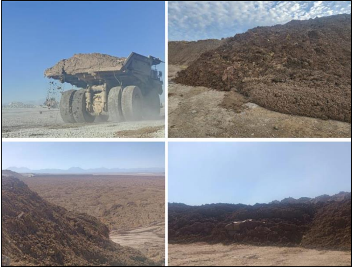
Figura 1.1. Fotografías del material residual post-lixiviación que evidencian los problemas actuales de inestabilidad estructural.
