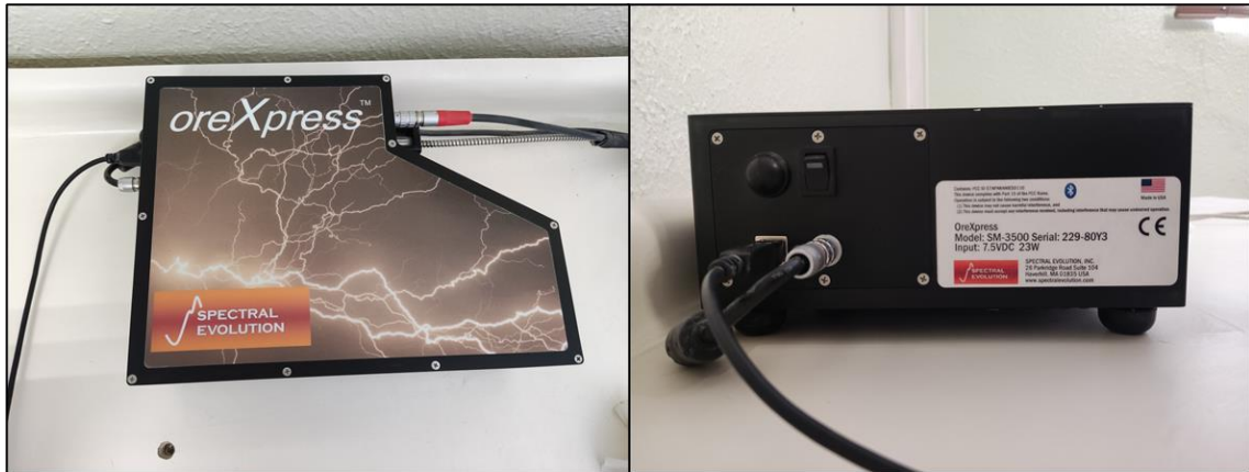
Figura 4.5. Fotografías del equipo NIR Spectral Evolution oreXpress modelo SM-3500.
