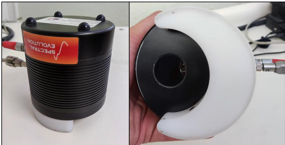
Figura 4.6. Fotografías de la benchtop reflectance probe o sonda de reflectancia de mesa. La fotografía de la izquierda muestra su posición de lectura, mientras que la derecha muestra el espacio donde se ubica la muestra y el orificio por el cual el equipo emite luz.
