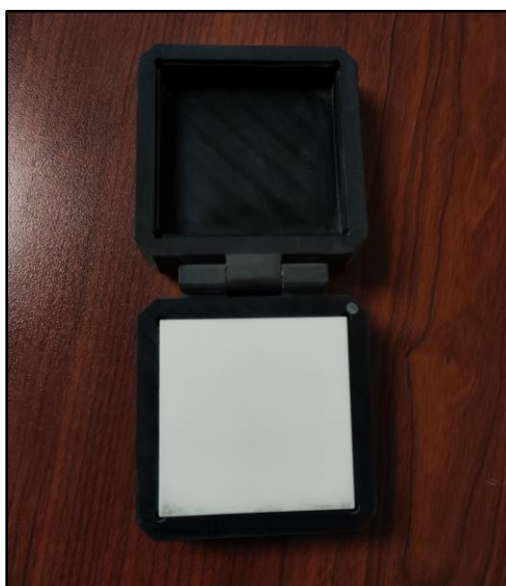
Figura 4.10. Fotografía del blanco de referencia utilizado para calibrar el equipo NIR.
