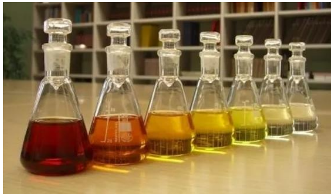
Figura 2.11. Aceite dieléctrico de un transformador
