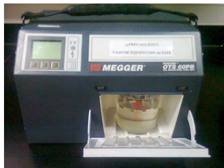
Figura N°3.19: Medidor de rigidez dieléctrica marca megger Modelo OTS 60 PB
