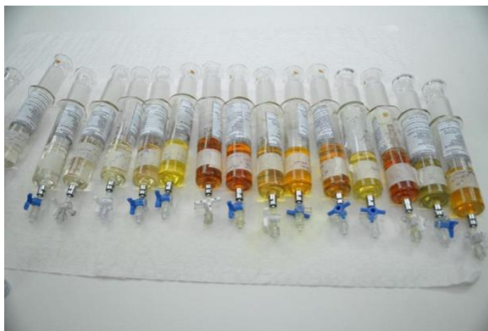
Figura 3.7. Toma de muestras de aceite y su degradación
