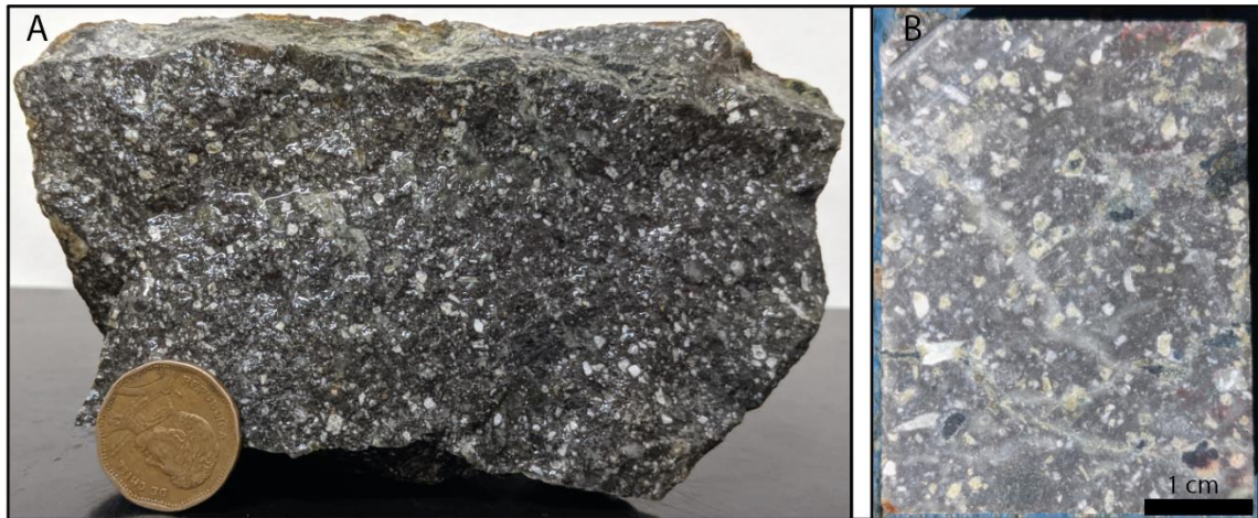
Figura 5-6. A) Muestra del pórfido diorítico, destacando la textura porfídica. B) Rechazo de la misma muestra A, destacando la alteración de las plagioclasas, vetillas de cuarzo + turmalina + pirita. Elaboración propia.
