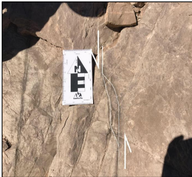
Figura 5.23. Estructuras sigmoidales observadas en fallas de rumbo de cinemática sinistral.
