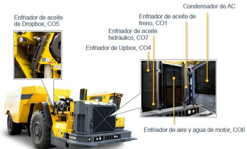
Figura N° 3.23: Conjunto de enfriadores.
