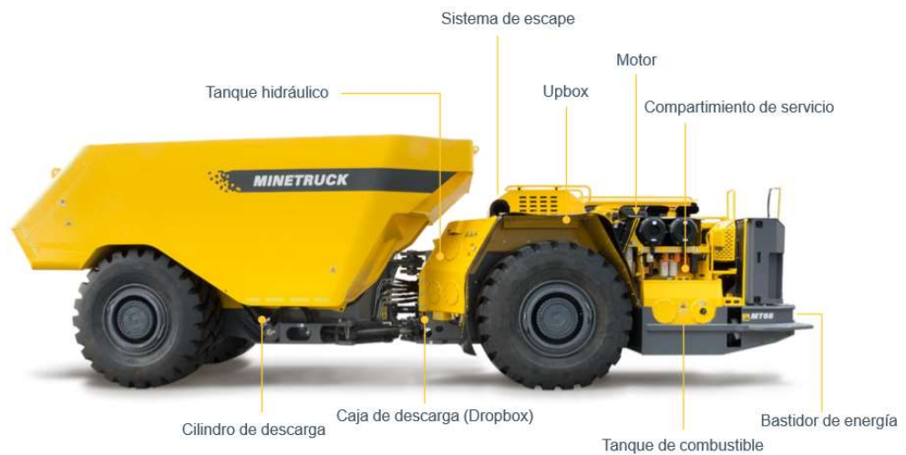
Figura N° 3.3: Componentes Camion MT-65.
