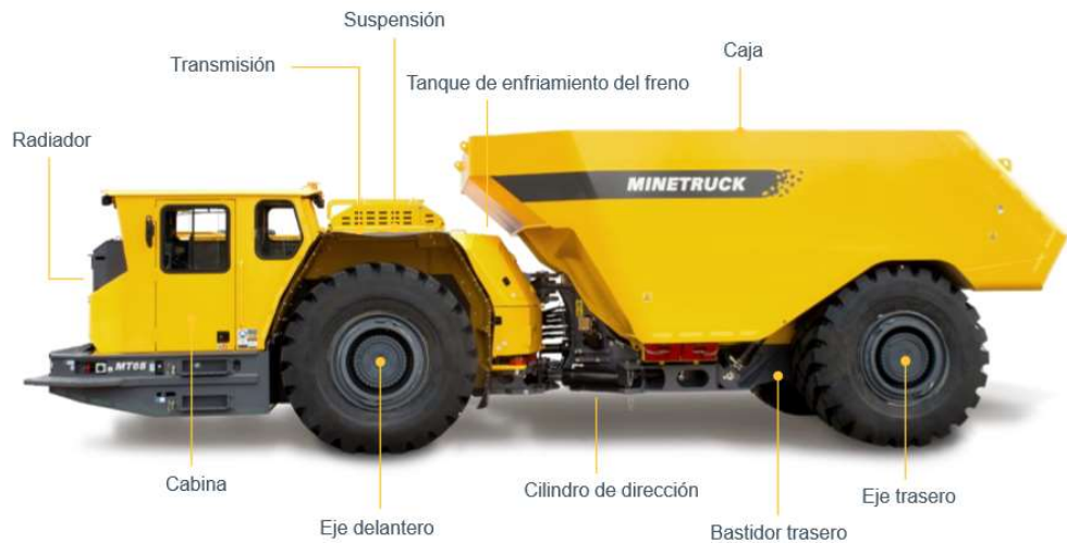
Figura N° 3.4: Componentes Camion MT-65.
