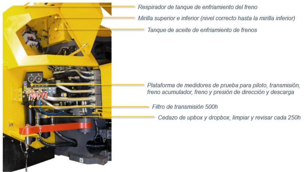
Figura N° 3.12: Box de testeo Hidráulico.
