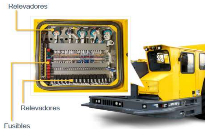
Figura N° 3.14: A10 Caja eléctrica montados en la cabina.
