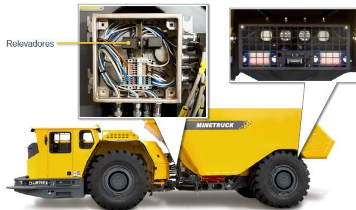
Figura N° 3.16: A30 Caja eléctrica de componentes principales.
