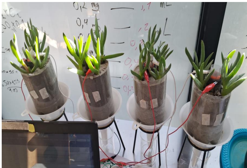
Figura 3.5 PFC conectadas al sistema Arduino.
