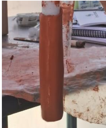
Figura 3.1 Membrana de arcilla utilizada como medio de intercambio protónico.
