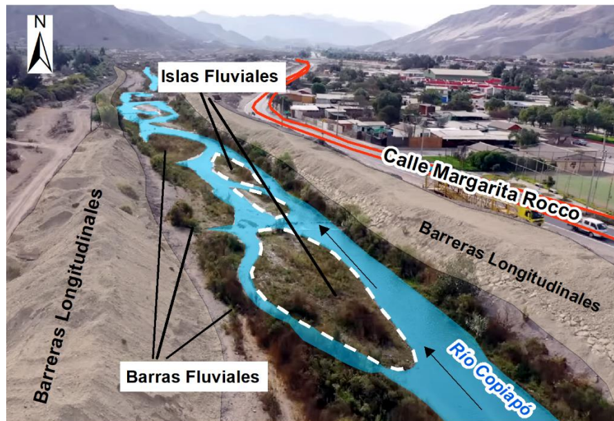
Figura 98: Imagen del cauce principal del río Copiapó correspondiente al mes de junio del 2019 en sector norte de la zona de estudio. Se destaca la presencia de vegetación, barreras de mitigación para estabilizar los márgenes del cauce y barras e islas fluviales alargadas dentro del cauce y en dirección del río. Extraído y modificado de Eltierramarillano.cl (agosto, 2023).
