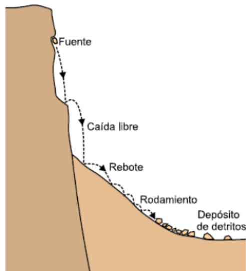
Figura 5: Ilustración de las partes de un desprendimiento o caída de rocas. Extraído de PMA (2008).
