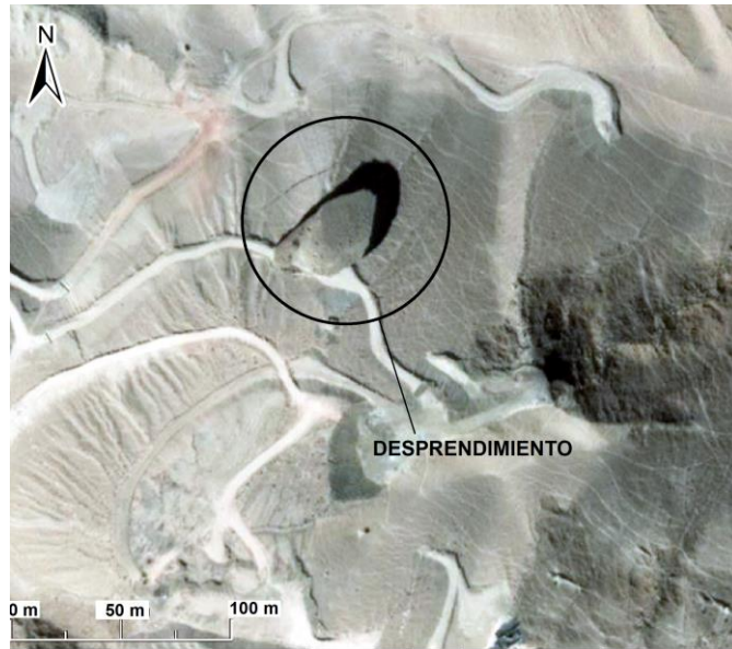
Figura 67: Desprendimiento de material en la ladera y remoción de material por socavamiento producido el año 2013 (Sánchez, 2016), con dimensiones de 20 m de diámetro y 30 m de profundidad, ubicado en los depósitos aluviales del abanico antiguo (terrenos pertenecientes a PUCOBRE). Se observa una serie de caminos y rutas, que corresponden al trayecto que realiza maquinaria minera. Imagen Modificada de Google Earth.
