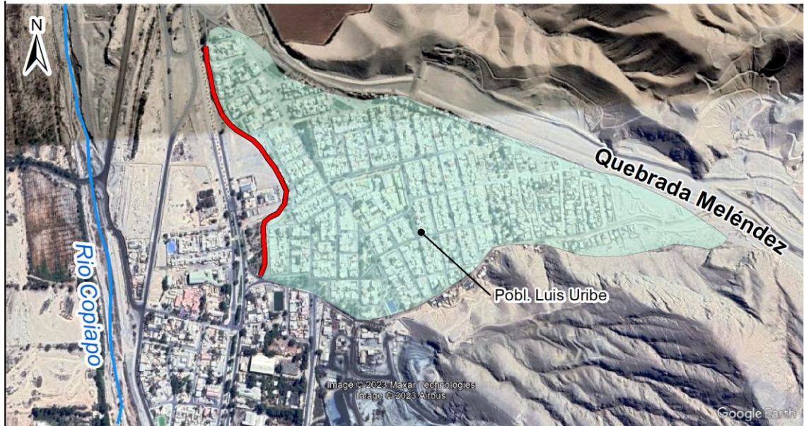
Figura 59: Imagen satelital de la unidad geomorfológica Abanico Aluvial Actual (superficie cubierta de color celeste). En línea continua de color rojo, está construido el muro (borde distal del abanico) en la cota 486 msnm (Modificado de Google Earth Pro).
