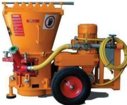
Figura 6.5 Equipo de shotcrete vía seca con "plato rotatorio"
