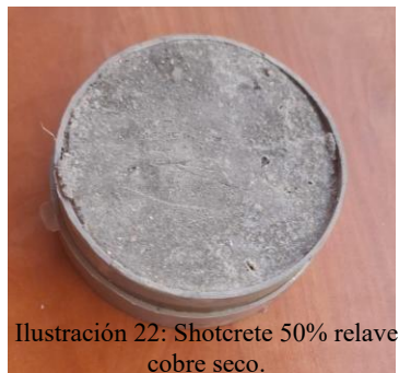
Figura 4.5 Shotcrete 50% relave cobre seco.
