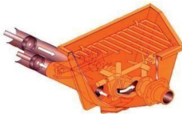
Figura 6.6a y 6.6b Detalle de bombeo para mezcla húmeda con desplazamiento positivo por pistón.
