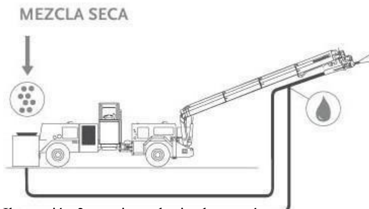
Ilustración 2 : equipo robotizado por vía seca. (Putzmeister, 2015)
