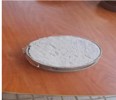
Ilustración 23: Shotcrete 50% relave hierro seco.
