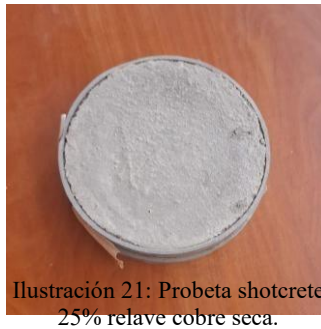
Figura 4.4 Probeta shotcrete 25% relave cobre seca. (Fuente: Elaboración propia)
