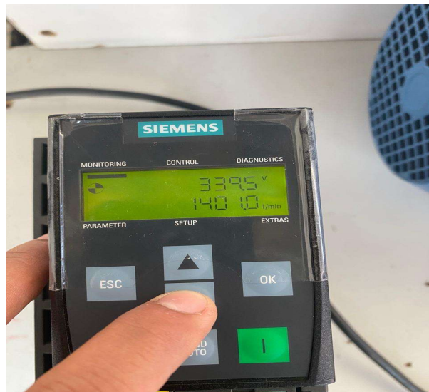
Figura N° 5.15 Parametrización de variador sinamic G120.
