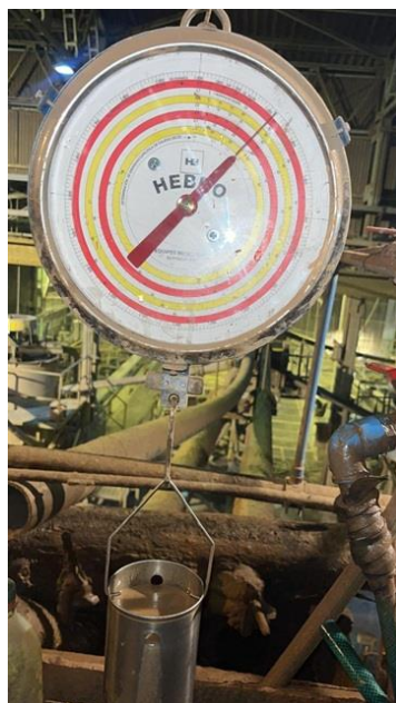
Figura 3.11. Determinación de la densidad de pulpa, proceso de flotación de oro
