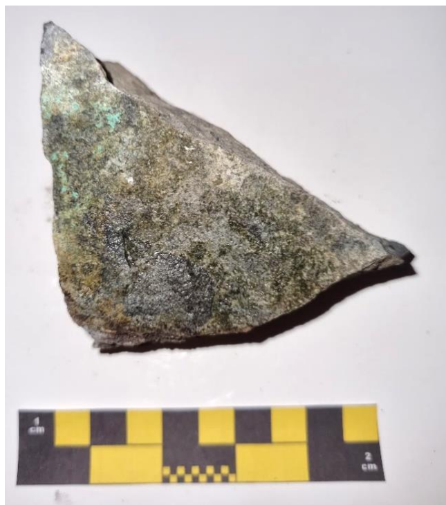
Figura 5.8: Muestra EP003, extraída en la coordenada 317202E, 6472782N. Andesita porfídica con fenocristales de tamaño fino hasta de 1 milímetro. No hay presencia de vesículas. El grado de alteración es leve a moderado. Índice de color máfico 85%. La mineralogía de alteración se compone por: epidotas reemplazando plagioclasas; clorita reemplazando ferromagnesianos presentes en la masa fundamental; y hematitas y goetitas diseminadas en la roca. Presenta magnetismo en la roca a causa de magnetita diseminada en la roca. Mineral de mena presente: crisocola en pequeña proporción.
