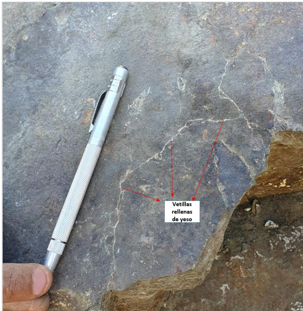
Figura 5.15. Vetillas de yeso hospedada en andesita obliterada producto de la alteración.
