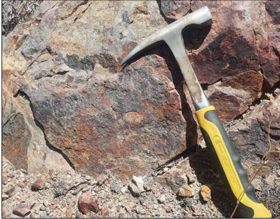
Figura 5.7. Andesita obliterada por alteración de hematita y jarosita.
