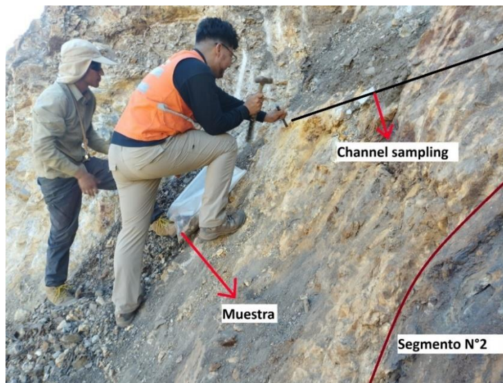
Figura 4.2. Extracción de muestra en el mediante el método Channel Sampling .
