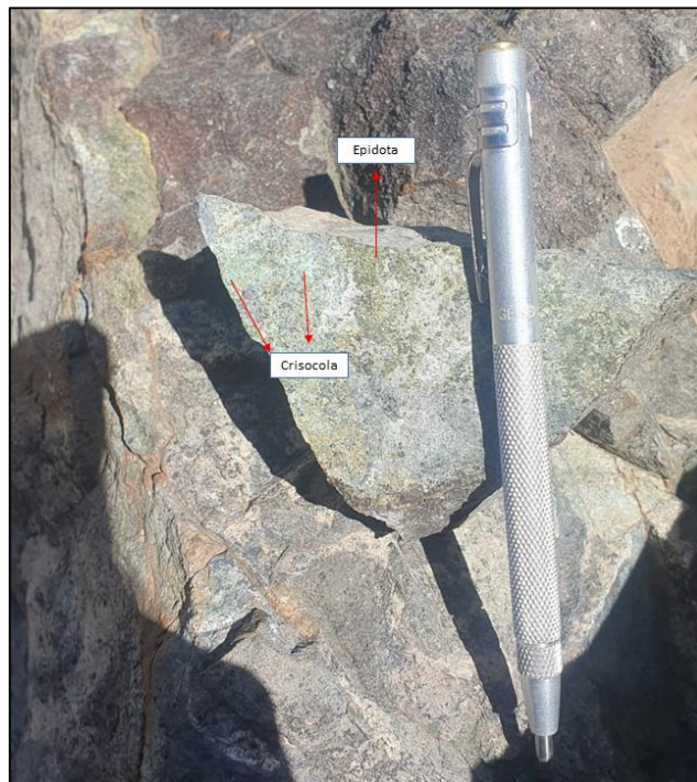
Figura 5.11. Muestra EP003, presenta grado de alteración media de epidota, hematita y goetita. La roca es de muy baja ley, y está asociada con crisocola.
