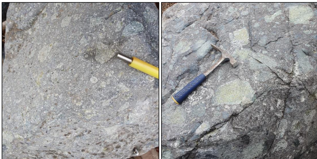
Figura 5.1. Brechas volcánicas andesíticas, presentan clastos cloritizados y masa fundamental de color marrón oscuro.
