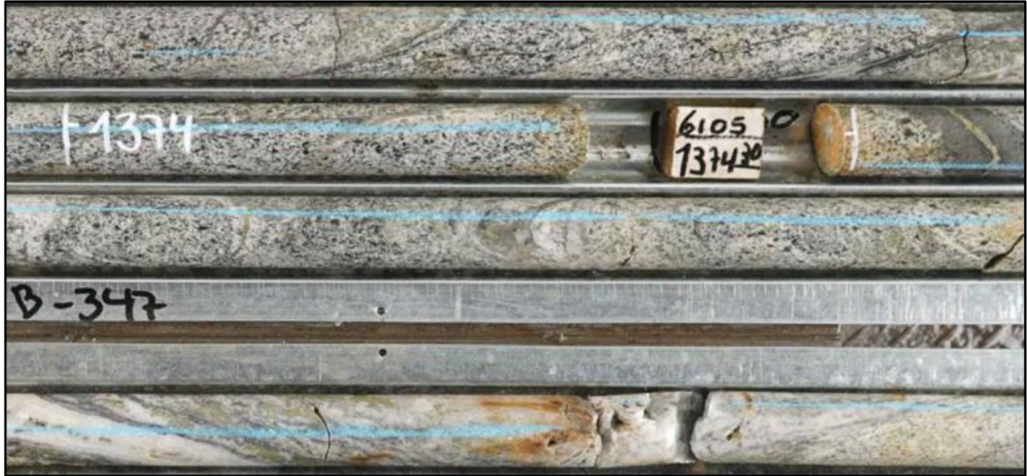
Figura 4.10: Fotografía. Roca de caja intrusiva Granodiorita Cascada con fuerte agrietamiento y cortada por vetillas tipo C, además vetillas tardías y tipo B, subparalelas al eje del sondaje.
