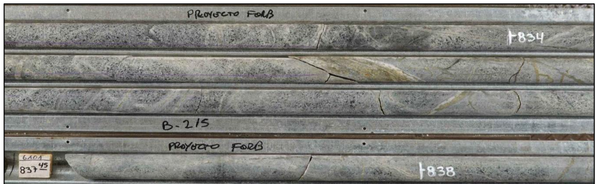
Figura 4.4: Fotografía. 6101 (836 m) Roca de caja intrusiva Granodiorita Cascada, agrietada y cortada en un primer evento por vetillas perpendiculares al eje del sondaje tipo B y C. Un segundo evento es definido por vetillas subparalelas al eje del sondaje, definido por vetillas tardías tipo E.
