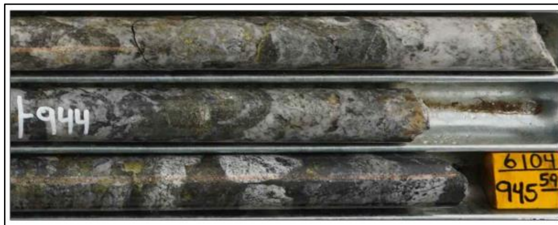
Figura 4.8: Fotografía. Brecha Hidrotermal de Biotita (BXB) a 944 m, matriz soportante de biotita y material polvo de roca, fragmentos de roca de caja intrusiva Granodiorita Cascada. Mineralización de cobre definida por calcopirita > bornita, ocurre en vetillas, cúmulo y diseminada en matriz de brecha, alcanza valores hasta 8.23% CuT.
