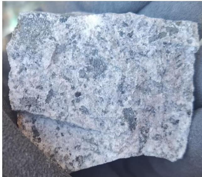
Figura 31: Muestra de diorita con alteración potásica de leve intensidad de UGT 03 de Fase 9 SE (Elaboración propia).
