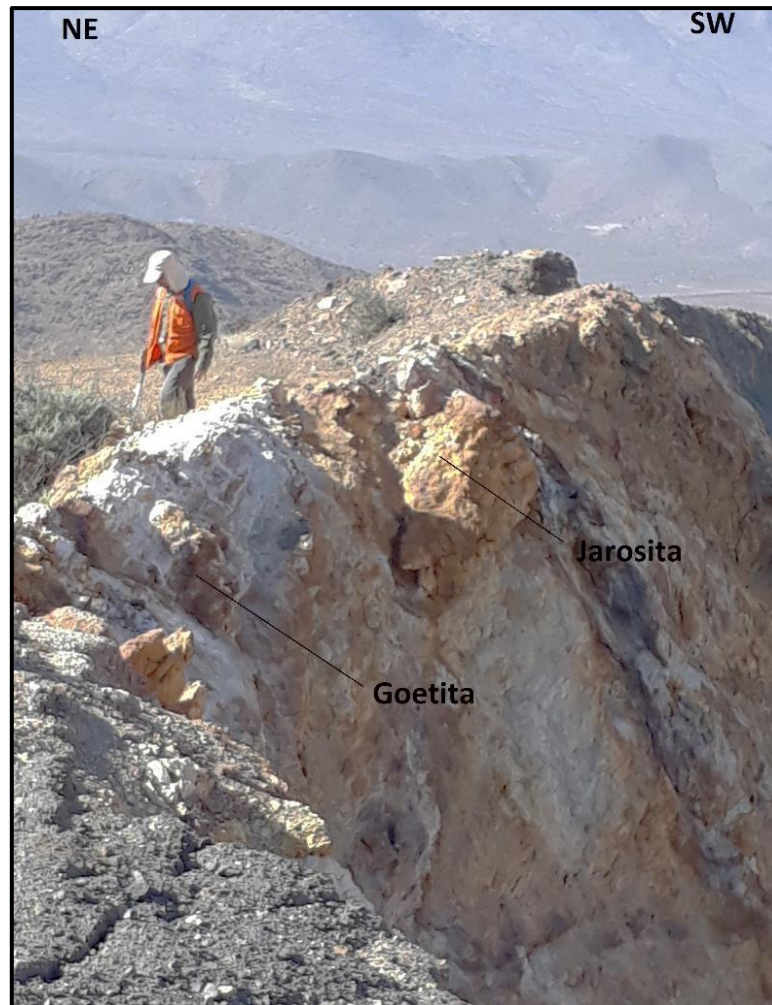
Figura 4.12 Superficie del rajo Huantemé, donde se observa la oxidación supergena que va alterando la mena ferrífera, con Jarosita (color naranja – amarillo) en mayor abundancia y Goetita (color rojo intenso).
