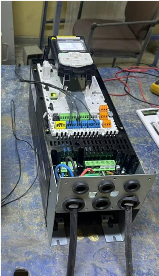
Figura N° 6.3: Variador de frecuencia ABB - ACS 880.
