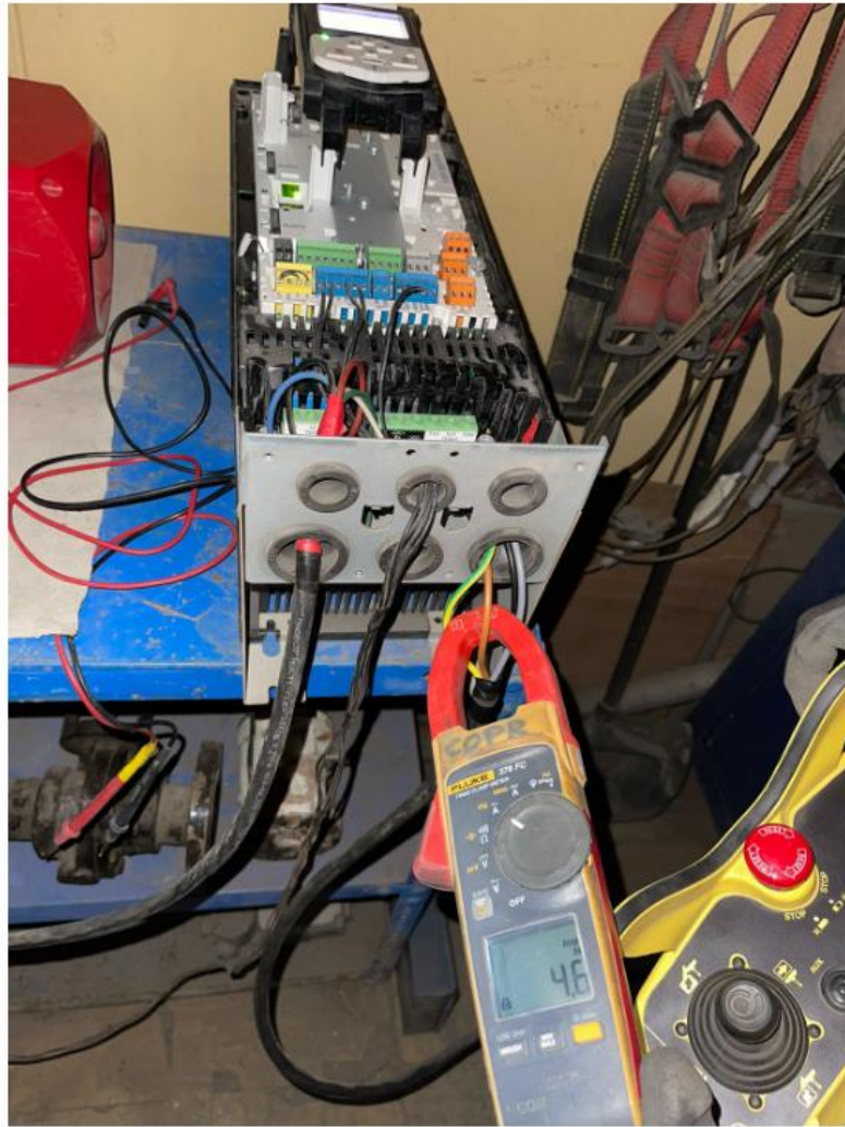
Figura N° 6.5: Medición de corriente de partida del motor.
