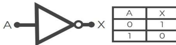
Figura N° 4.15: Compuerta lógica NOT.
