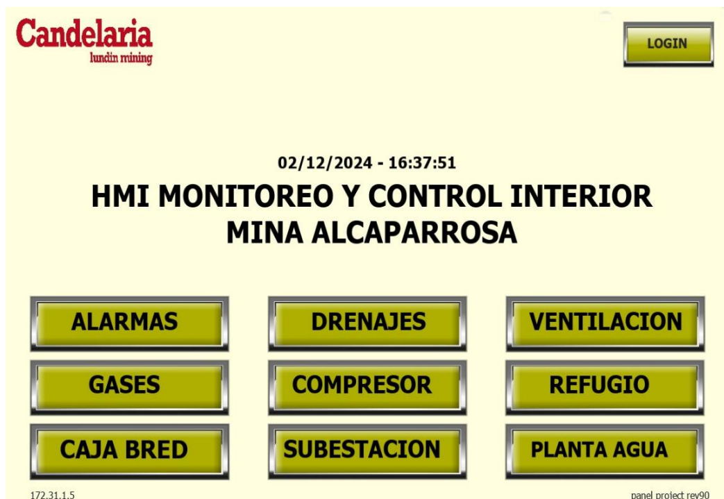
Figura N°2.1: Pantalla de monitoreo de Control en Operaciones Mina Alcaparrosa
