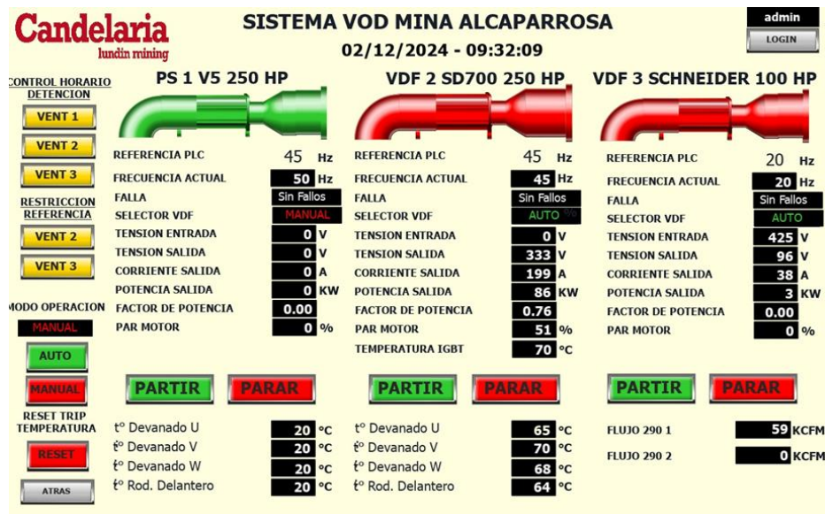
Figura N° 2.6: Pantalla de control y monitoreo ventiladores principales Mina Alcaparrosa
