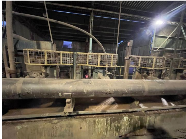
Figura 2.9. Celdas Rougher circuito principal Planta ENAMI Vallenar
