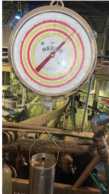
Figura 3.11. Determinación de la densidad de pulpa, proceso de flotación de oro
