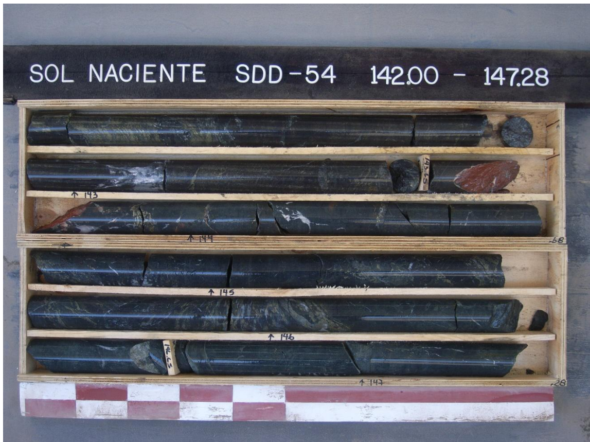
Figura 3.4: Sondaje de diamantina SDD-54 desde 142,00 a 110,06 metros. Se observa la presencia de mineralización de calcopirita fuertemente diseminada y pirita moderadamente diseminada, algunas vetillas de calcita, alteración de clorita leve, hematita muy leve y, según el mapeo geológico de este sondaje, también hay magnetita muy leve (Atacama Kozan, 2024c).
