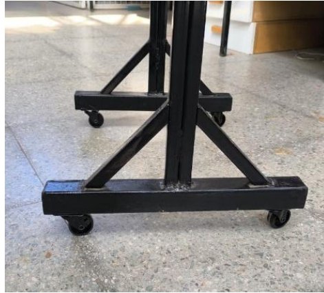
Figura N°3.5: Instalación de Ruedas
