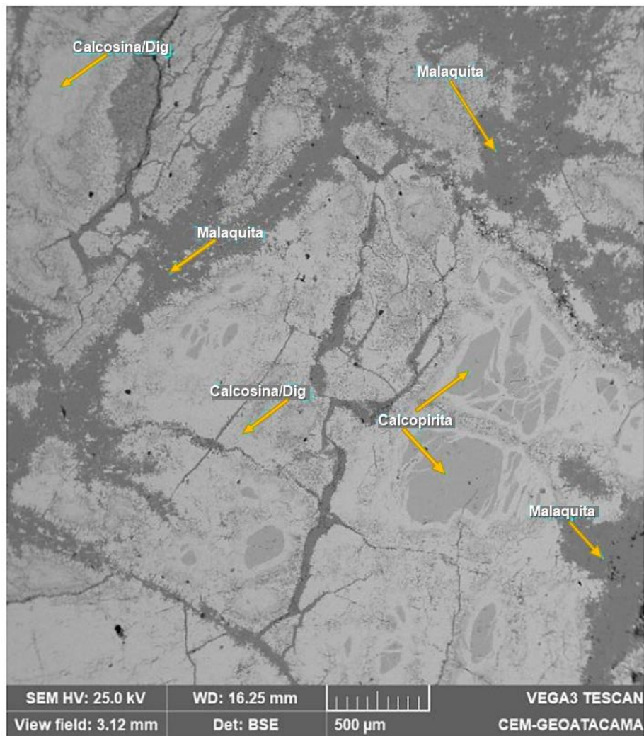
Fig. 5.6: Mapa elemental zonal en SEM-EDS, donde se ve la distribución de distintos minerales.
