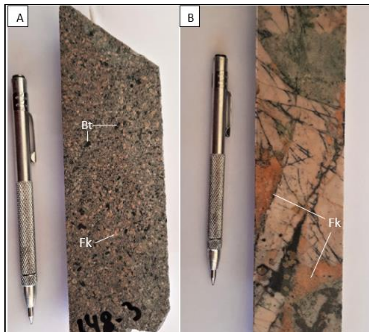
Figura 5.46 Muestras correspondientes al evento definido como potásico, representativas del sondaje SD0009. A) Tramo 147 al 148 m, se puede observar alteración potásica selectiva, las plagioclasas del protolito son remplazadas selectivamente a feldespato potásico (Kf) y los minerales máficos son reemplazados por biotita secundaria (Bt). B) Tramo 121 a 122 m, con alteración potásica penetrativa en rocas córneas, feldespato potásico (Fk) alterando de manera pervasiva a la roca.
