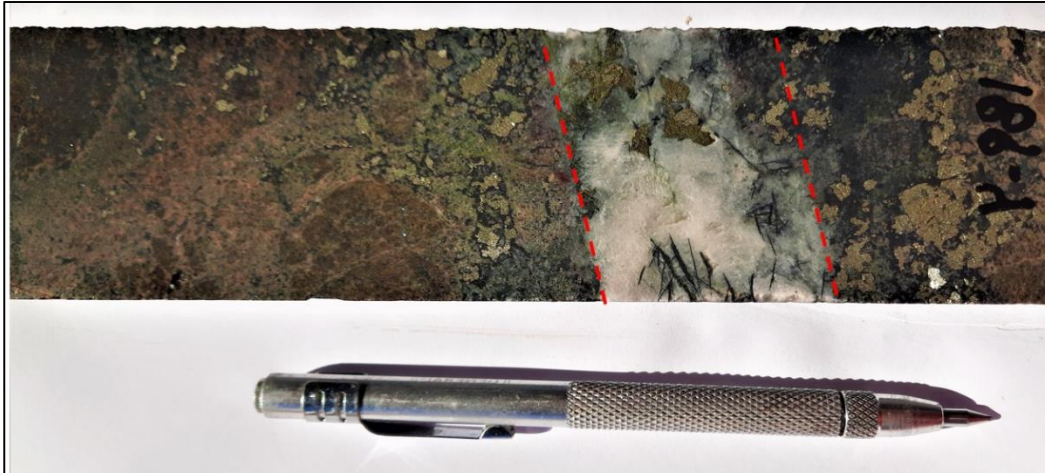
Figura 5.52: Muestra del sondaje SD009, correspondiente a una roca skarn de granate, se puede observar una vetilla de cuarzo que corta la roca y esta sobre una alteración de tipo sódico cálcica, caracterizada con la presencia de actinolita, magnetita y epidota.
