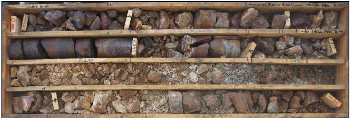
Figura 5.55: Tramo 0 a 4 m del sondaje SD0022. Roca fracturada y alterada de manera pervasiva, presenta abundante hematita y jarosita.
