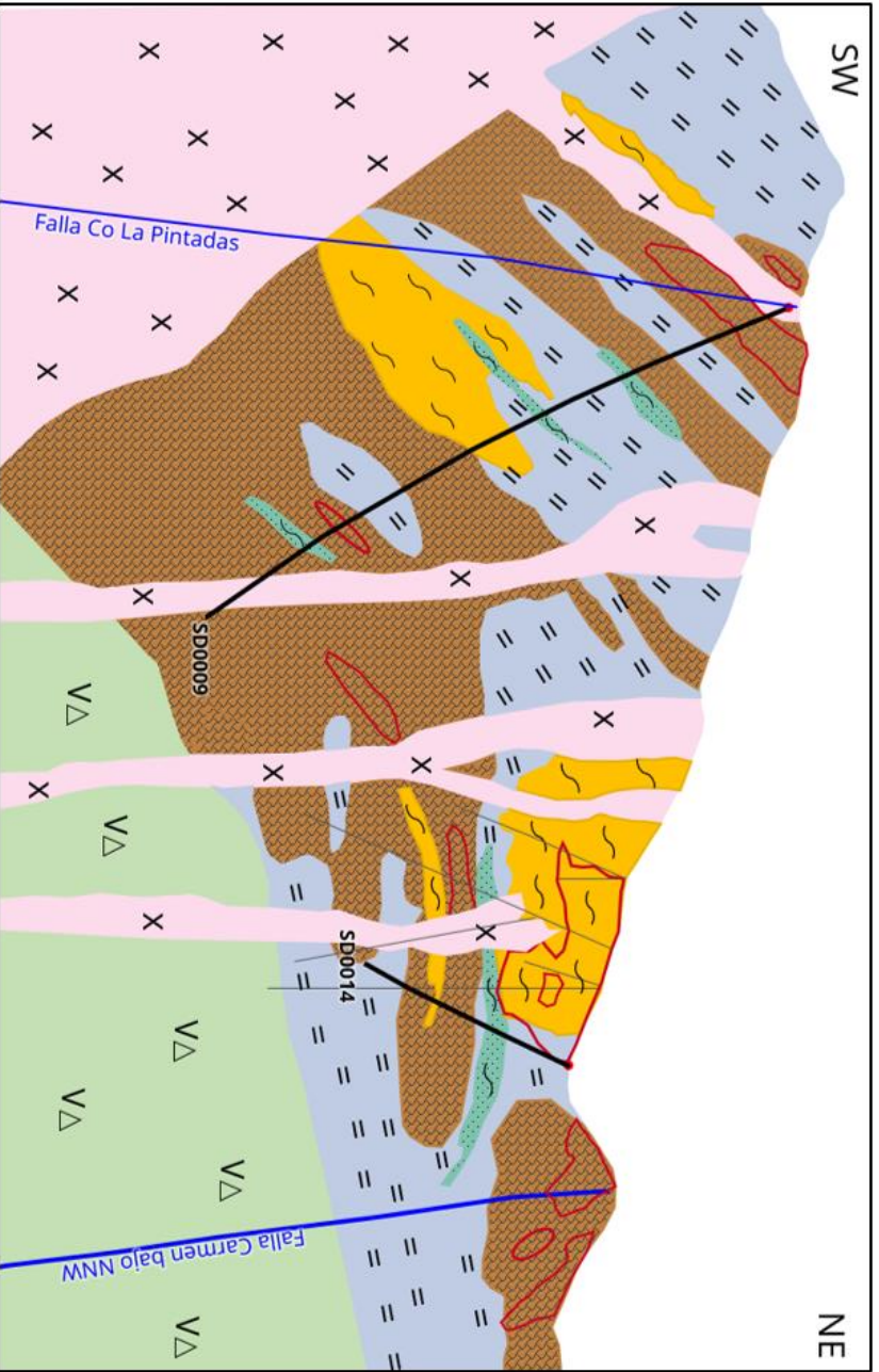
Figura 6.1: Sección simplificada del proyecto Soploná, de acuerdo a información geológica de mapeo de sondajes SID00009 y SID0014. (Elaboración propia).
