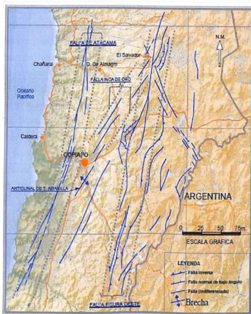
Figura 3.2: Mapa de estructuras regionales, se observa Anticlinal de Tierra Amarilla y Sistema de Falla de Atacama (Modificado de Mpodozis y Allmendinger, 1993).
