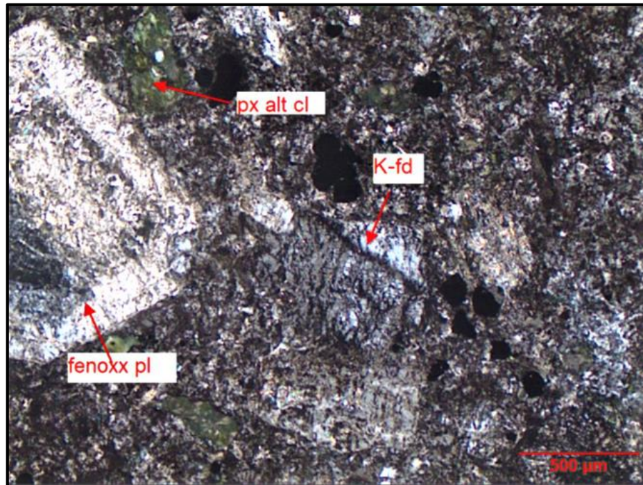
Figura 5.20: Muestra SD14-140m. Dique Diorítico de piroxenos y anfíbol. Aspecto de la textura porfídica con orientación magmática de los fenocristales de plagioclasa zonados y maclados y también, fenocristales de feldespato potásico con macla de Carlsbad. Las fases intersticiales tienen composición felsítica oscura con piroxenos alterados a clorita, sin presencia de cuarzo. Nícoles cruzados aumento 5 x 14.
