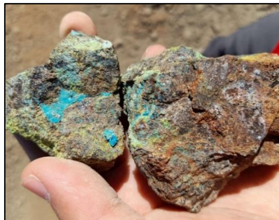
Figura 5.41: Muestra de afloramiento con alteración asociada a actinolita, epidota y magnetita alterada a hematita y jarosita.
