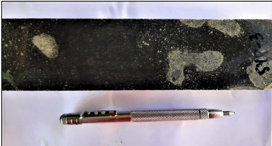
Figura 5.16: Muestra representativa del tramo 548 al 549 m del sondaje SD0007, donde se aprecia unidad de andesitas, se observa una roca con aspecto brechoso
