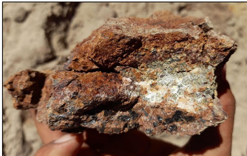
Figura 5.56: Roca alterada penetrativamente, presenta magnetita alterada a hematita (Hem) y jarosita (Jar), también se puede observar arcillas (Arc).
