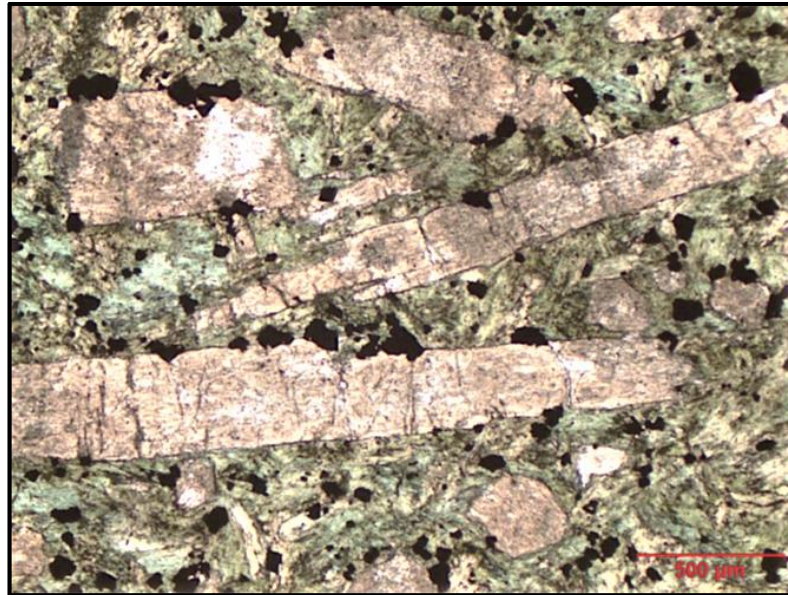
Figura 5.7: Muestra SD14-249m. “Esquisto” de calcosilicatos, con porfidoblastos orientados de escapolita. La textura grano-nematoblástica con orientación marcada de porfidoblastos de escapolita prismática (¿reemplazo de plagioclasas?), en una matriz oscura de anfíbola de color verde pasto, que corresponde a hornblenda actinolítica con gránulos opacos de magnetita. La escapolita está alterada a láminas de albita con arcillas. Nícoles paralelos, aumento 5 x 14.
