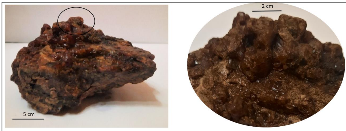
Figura 5.39: Rocas con alteración calco-silicatada. Se destaca en la imagen granates cafés correspondientes a esta alteración.
