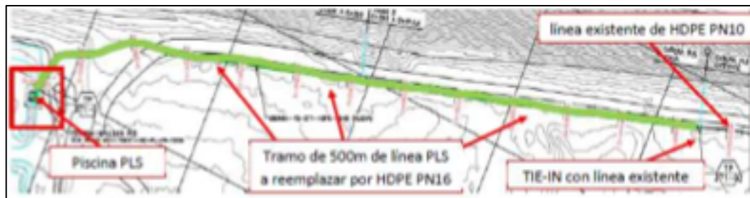
Figura N°4.6: Montaje de 500 metros.
