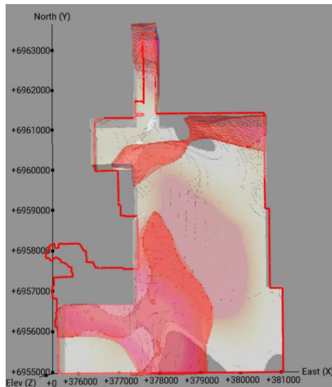
Figura 6.6. Vista en planta de los cuerpos 3-D definidos por altos valores del modelo susceptibilidad magnética (escala de rojo a rosado) ( >0,004 SI) y altos valores del modelo MVI (escala de blanco a anaranjado) ( >0,006 SI). En
