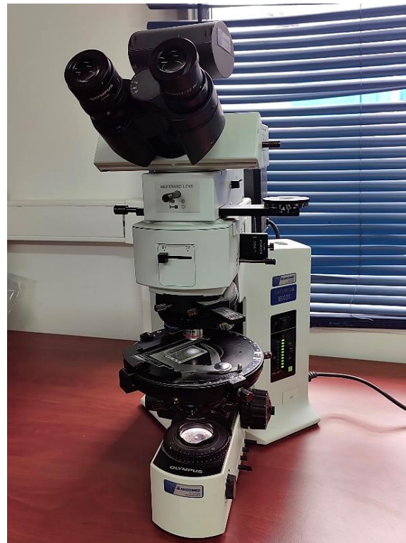
Figura 4.8. Microscopio petrográfico Olympus BX51 utilizado para análisis de cortes transparentes seleccionados.
