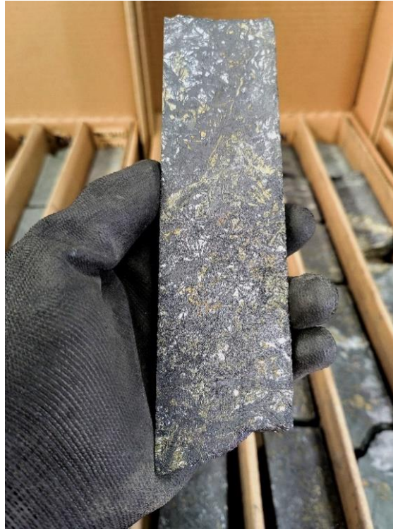
Figura 4.5. Fragmento de sondaje (NQ) referencial donde se realizó logueo geológico y medición de susceptibilidad magnética. La muestra corresponde a una andesita con mineralización metálica de calcopirita, pirita, magnetita y mushketovita.
