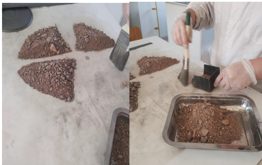
Figura 3.9: Figura derecha cuarteo de muestra y figura izquierda muestra escogida para tamizar.
