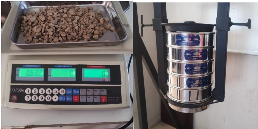
Figura 3.5: Figura derecha 632 gramos que se utilizaran para tamizar en el ro-tap y figura izquierda tamices de forma descendente en el ro-tap
