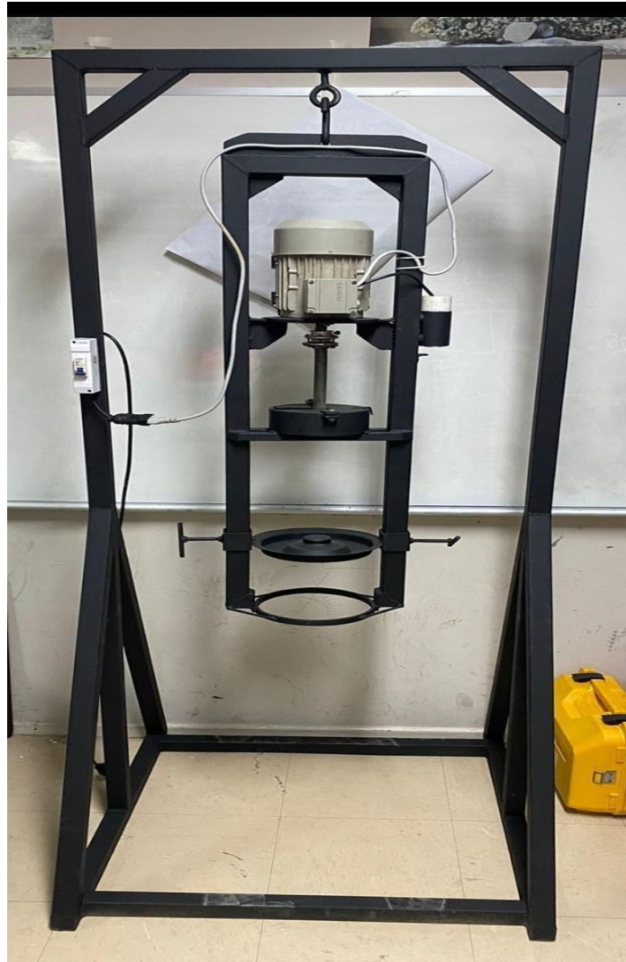
Figura 4.6: Equipo ro-tap instalado en el laboratorio de la Universidad de Atacama, Sede Vallenar.
