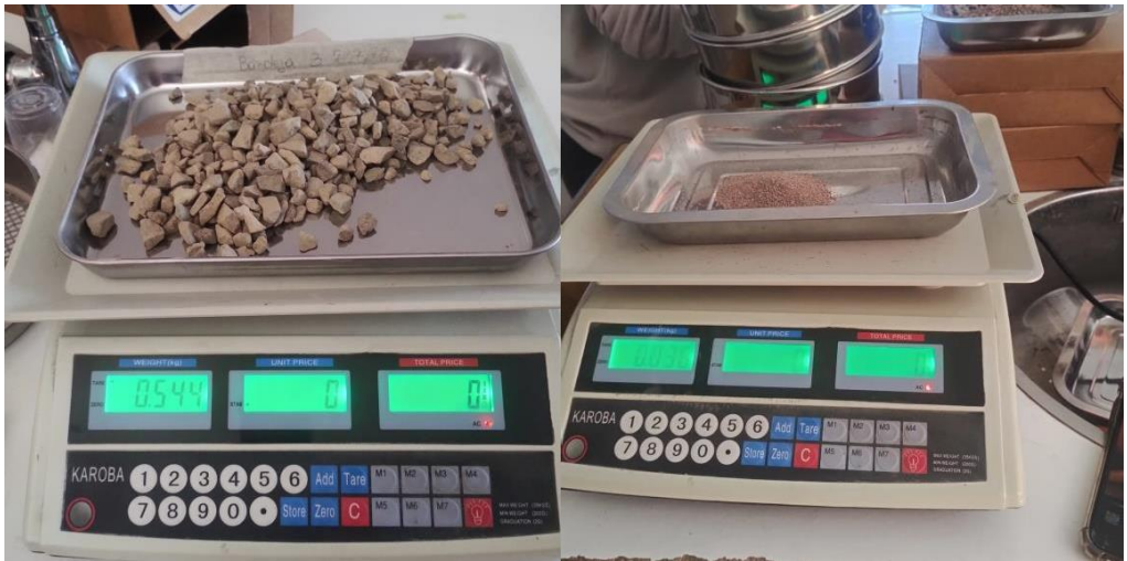
Figura 3.6: Figura derecha mineral retenida en el tamiz 4 y la figura izquierda mineral retenida en el fondo -100.
