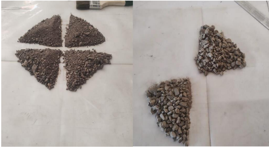
Figura 3.4: Torta dividida en 4 partes y dos partes se utilizaran para tamizar en el rotap.
