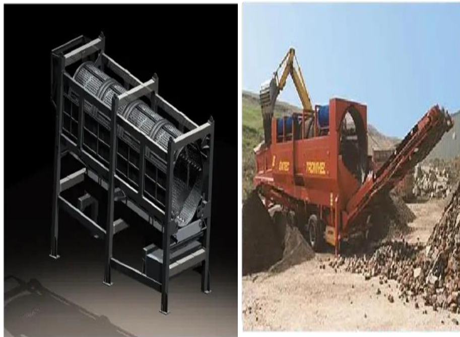
Figura 2.12: la figura derecha muestra un harnero “Trommel” y al lado izquierdo se muestra como un harnero “Trommel” clasifica el mineral.
