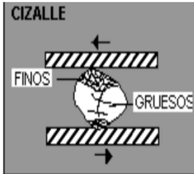
Figura 2.11 Mecanismo de Conminucion (cizalle).
