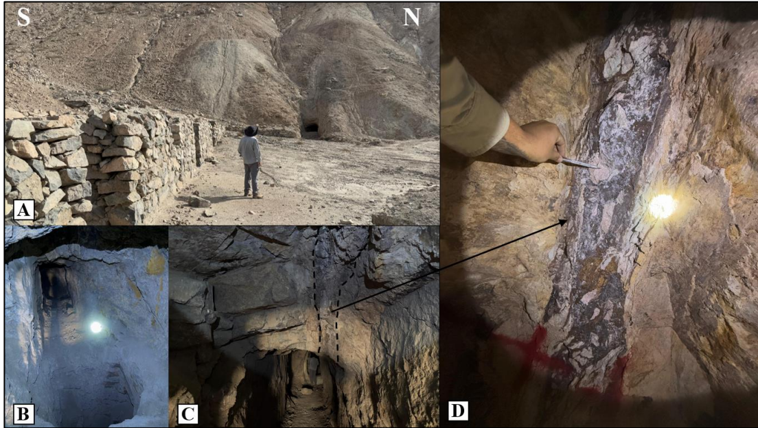
Figura 26. Mina Alacrán. A. Vista de la entrada principal de la mina Alacrán, parcialmente cubierta por depósitos aluviales. B. Pique vertical que conecta con niveles inferiores, actualmente inaccesibles. C. Túnel principal de la mina, donde se observa continuidad de labores subterráneas y la traza de una veta en el techo. D. Sección de veta brechada, con fragmentos líticos angulosos contenidos en una matriz compuesta por minerales oscuros, donde destacan óxidos de manganeso, arsénico y, en menor proporción, cobre.
