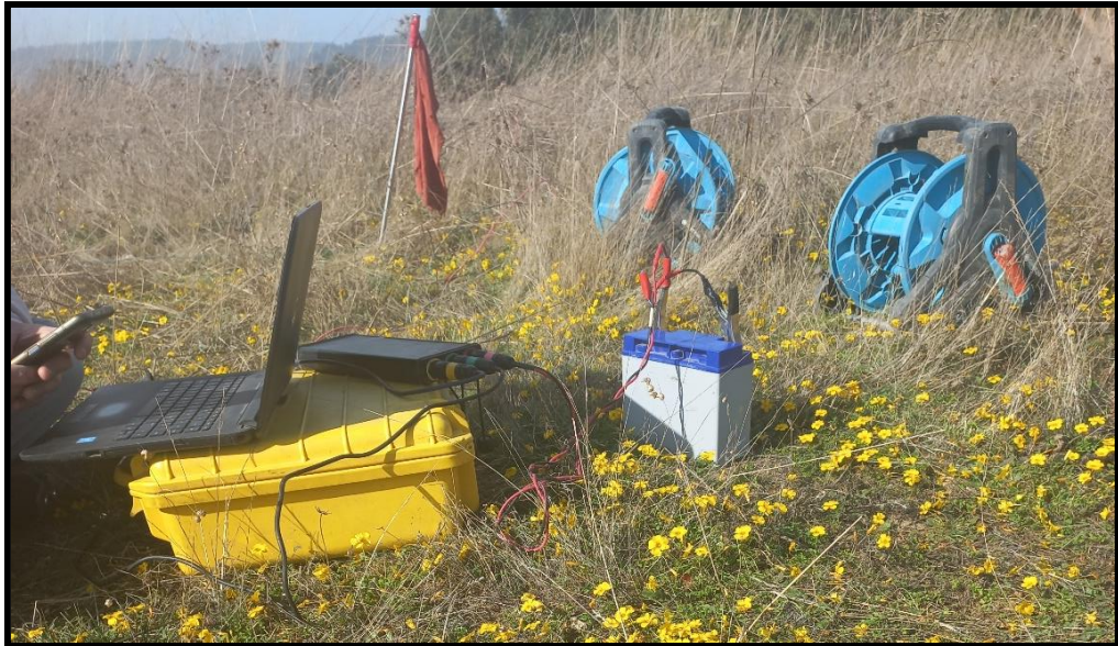
Figura 4.3. Materiales utilizados para la realizar las mediciones geofísicas.
