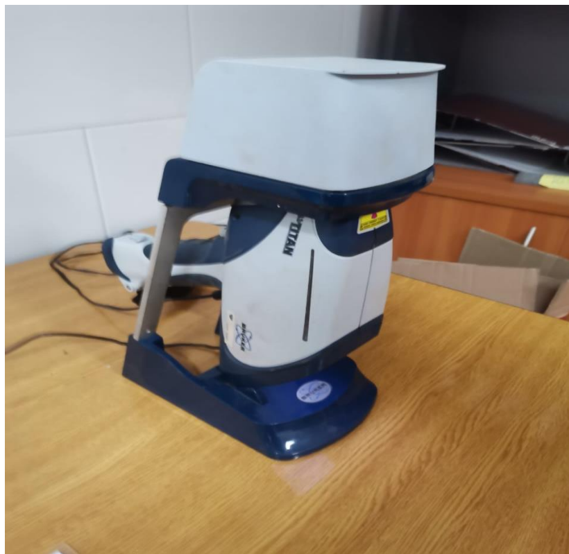
Figura 13: Espectrómetro portátil de fluorescencia de rayos X (XRF) modelo S1 TITAN de Bruker, utilizado para el análisis elemental de las 47 muestras en el Laboratorio de Geología Económica de la Universidad de Atacama (Elaboración propia).
