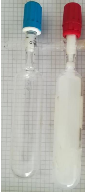
Figura 16: Ampolla de Giggenbach utilizada para el muestreo de gases. Se observan dos ampollas: sin solución alcalina para isótopos de gases nobles (izquierda) y otra con la solución alcalina previo al muestreo de gases (derecha). Extraído y modificado de Inostroza (2020).
