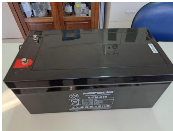
Figura N° 3.11: Batería de ciclo profundo.
