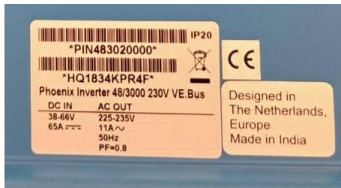
Figura N° 3.17: Datos técnicos del inversor de corriente.
