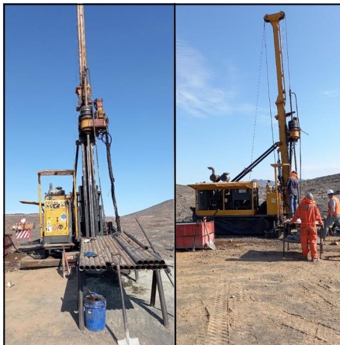
Figura 4.1: Equipo de sondaje DRX-700, diámetro NQ, rotación horaria.
