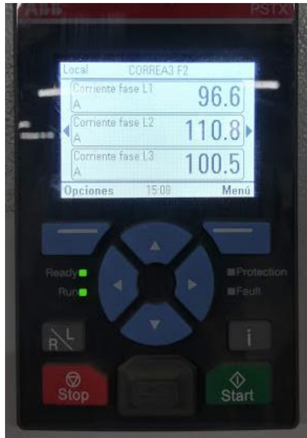
Fig. 3.12 Funcionamiento del motor en vacío
