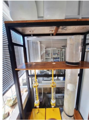
Fig. 3.15 Instalación del sistema de goteo para cada columna
