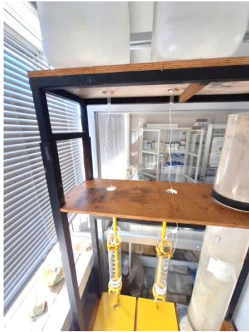
Fig. 3.15 Instalación del sistema de goteo para cada columna
