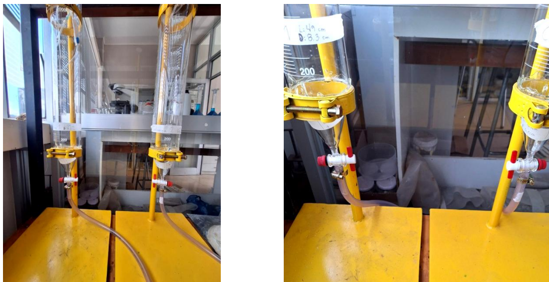
Fig. 3.26 Columnas de lixiviación construidas y armadas con todos sus implementos listos
