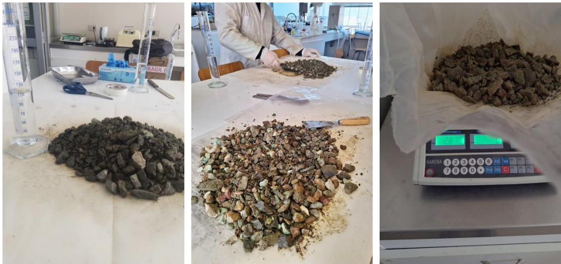
Fig. 3.20 Aglomeración del mineral con una humedad de 2,6 %
