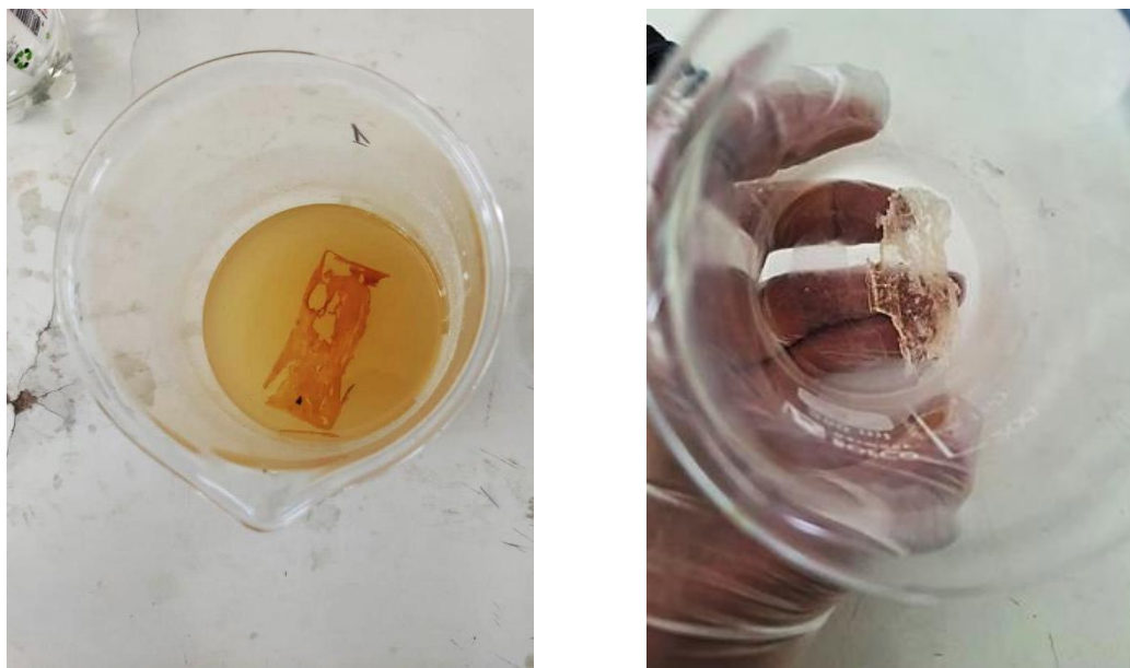
Fig. 3.14 Prueba de resistencia del durepoxi con ácido 1N
