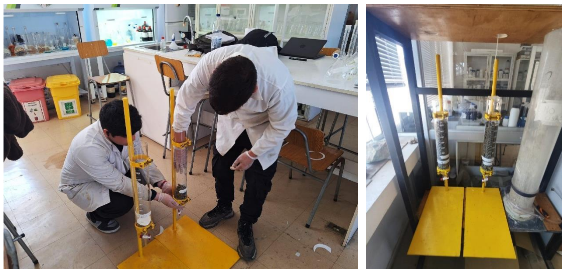
Fig. 3.21 Carguío de ambas columnas con el material aglomerado al 2,6% de humedad
