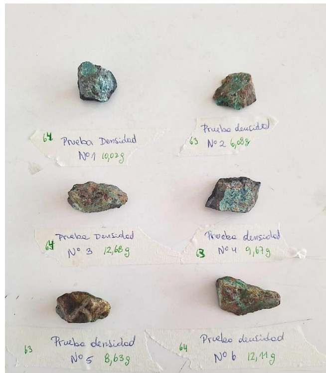
Fig. 3.16 Medición de la densidad con tamaños intermedios del material utilizando una probeta de 100 mL
