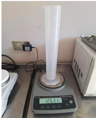
Fig.3.17 Probeta plástica de 500 cc para la prueba del peso específico aparente
